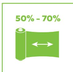
Zalecany rozciąg folii to 50% - 70%. Aby sprawdzić prawidłowość rozciągu, zaznacz 2 punkty na rolce folii w odległości 10 cm, po przejściu przez wałki rozciągające na owijarce, punkty powinny być oddalone od siebie od 15 do 17 cm. Aby zapewnić optymalny rozciąg. Wałki urządzenia powinny być regularnie kontrolowane i czyszczone.
