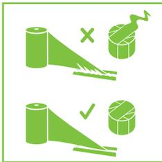
Besonderes Augenmerk sollte auf die Schärfe und den technischen Zustand der Schneidmesser gelegt werden, um eine gute Haftung der Folie zu gewährleisten und eventuellen Streifen zu beseitigen.
