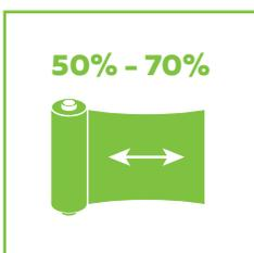
Die empfohlene Dehnung der Folie beträgt 50% - 70%. Um zu überprüfen, ob die Dehnung korrekt ist, markieren Sie 2 Punkte auf der Folienrolle im Abstand von 10 cm, nach dem Durchlaufen der Dehnungsrollen der Wickelmaschine sollten die Punkte 15 bis 17 cm voneinander entfernt sein. Um eine optimale Dehnung zu gewährleisten, sollten die Walzen der Maschine regelmäßig kontrolliert und gereinigt werden.
